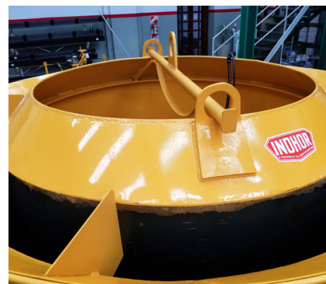
Gancho de Izaje para remoción de Molde Interior.
