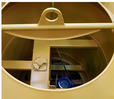
Vista Molde Interior con motor y elemento vibrador.
