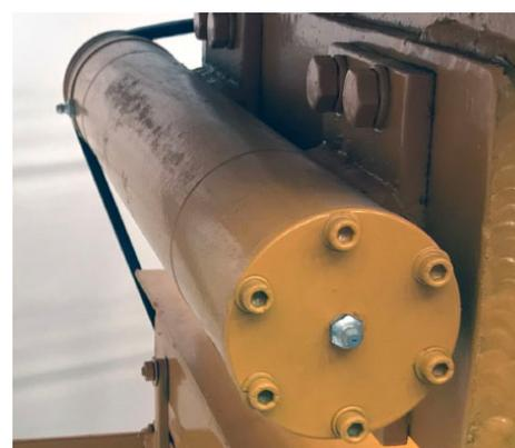
Vibrador de alta frecuencia
